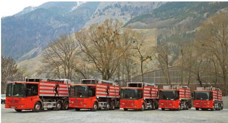
Zum Jahresstart konnte der fünfte FAUN POWERPRESS mit 3-Tonnen-Heckkran für die Aufnahme von Unterflursammelbehältern mit 3.000 l Fassungsvermögen im Kanton Graubünden bei der Stadt Chur in Betrieb genommen werden
