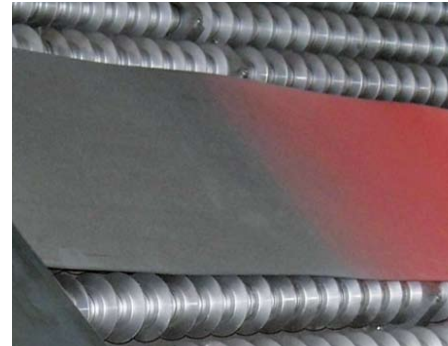
Partiell temperierte Platine
