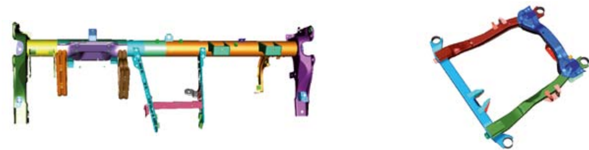
Beispiele für komplexe Metallstrukturen aus polnischer Fertigung: Armaturentafel- und Motorträger
